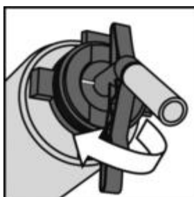
Ilustracja 2: AA210 Spray Nozzle przekręcić o jedną czwartą obrotu.
